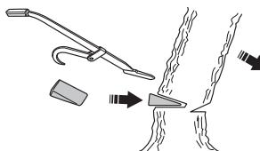
Мы рекомендуем пользоваться шиной пилы, длина которой бы превышала диаметр ствола, чтобы валивший и направляющий срезы могли выполняться т.н. "одинарным срезом". См. указания в разделе Технические данные,
