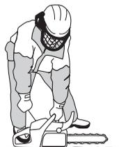
Твердо возьмите моторную пилу, обхватив ручки всей ладонью.
