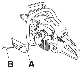
Они уменьшают доступ холодного воздуха и предохраняют от попадания большого количества снега в пространство карбюратора.
