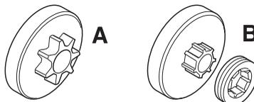
Следует регулярно проверять степень износа звездочки привода. Заменять при сильном износе. При замене цепи следует одновременно заменять и звездочку привода.
