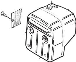
Bestimmte Schalldämpfer sind mit einem speziellen Funkenfangnetz ausgerüstet. Ist Ihr Gerät mit einem derartigen Schalldämpfer ausgestattet, so ist das Netz einmal wöchentlich zu säubern. Dies geschieht am besten mit einer Stahlbürste. Bei Verstopfung des Netzes läuft der Motor heiß, was schwere Motorschäden zur Folge haben kann.
