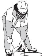
Takoj ko motor poskuša vžgati, potisnite ročico čoka navznoter, nato pa nadaljujte s poskusi, dokler motor ne vžge. Ko motor vžge, hitro dodajte polni plin; zagonski plin se samodejno izklopi.
