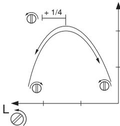
**ACHTUNG!** Wenn sich die Kette im Leerlauf dreht, ist die Schraube T gegen den Uhrzeigersinn zu schrauben, bis die Kette sich nicht mehr bewegt.
