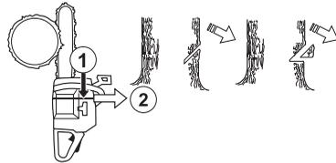
Die Schnitttiefe der Kerbe soll etwa 1/4 des Stammdurchmessers und der Winkel zwischen dem oberen und unteren Schnitt mindestens 45° betragen.
