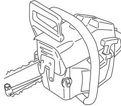
Die Kette ist richtig gespannt, wenn sie an der Schienenunterseite nicht durchhängt und noch leicht von Hand durchgezogen werden kann. Die Schienenspitze anheben und dabei gleichzeitig die Schienenmutter mit dem Kombischlüssel festschrauben.
