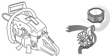
**POMEMBNO!** Učinkovitost centrifugalnega čiščenja je odvisna od rednega vzdrževanja in nege. Očistite dovod zraka v zaganjalnik, krila ventilatorja, prostor okrog ventilatorja, dovodno cev in komoro uplinjača.
