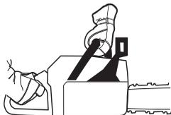
Poženite motor s polnim plinom in sprožite zavoro verige, tako da z levim zapetjem odsunete ščitnik odsunka. Pri tem ne
