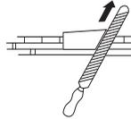
• So schärfen, dass alle Zähne gleich lang sind. Wenn die Schneidezähne bis auf 4 mm (5/32") Länge abgenutzt sind, ist die Sägekette unbrauchbar und muss weggeworfen werden.
