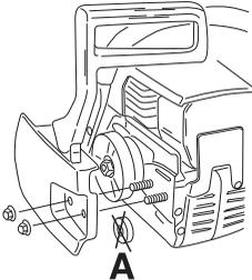
Die Schiene über die Schienenbolzen montieren. Die Schiene in der hintersten Position aufsetzen. Die Kette um das Kettenantriebsrad und in die Schienennut legen. Auf der Oberseite der Schiene beginnen.
