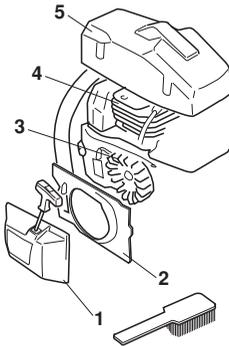
Das Kühlsystem einmal pro Woche mit einer Bürste reinigen, bei schwierigen Verhältnissen öfter. Eine Verschmutzung oder Verstopfung des Kühlsystems führt zur Überhitzung des Gerätes, die Schäden an Zylinder und Kolben zur Folge haben kann.
