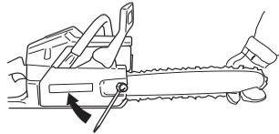
An einer neuen Kette muss die Kettenspannung oft kontrolliert werden, bis die Kette eingefahren ist. Die Kettenspannung regelmäßig prüfen. Mit einer richtig gespannten Kette wird eine gute Schnittleistung und eine lange Lebensdauer erzielt.
