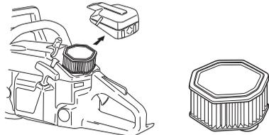
Eine gründlichere Reinigung erfolgt durch Auswaschen des Filters in Seifenwasser.
