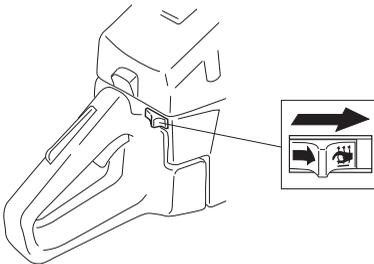
Wird der Schalter nach rechts geschoben, schaltet sich die Heizung ein. Wird der Schalter nach links geschoben, schaltet sich die Heizung aus.
