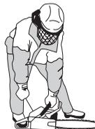
Sobald der Motor zündet, den Chokehebel einschieben und neue Startversuche machen, bis der Motor anspringt. Wenn der Motor anspringt, schnell Vollgas geben, und das Startgas schaltet sich automatisch aus.
