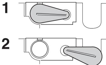
**ACHTUNG!** Wenn der Stopfen in die Luftdüse für die "Air Injection" gesetzt wird, ist der Luftfilter mindestens einmal pro Tag zu reinigen.
