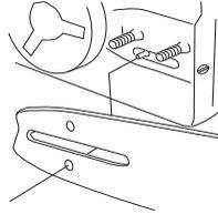
Verigo napnite s kombiniranim ključem tako, da obračate vijak za napenjanje verige v smeri urinega kazalca. Verigo napenjajte toliko časa, da ne bo več ohlapno visela s spodnjega roba meča.
