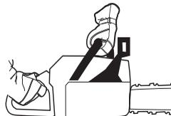
Geben Sie Vollgas und betätigen Sie die Kettenbremse, in dem Sie das linke Handgelenk gegen den Handschutz
