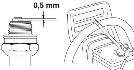
Hinweis! Stets den vom Hersteller empfohlenen Zündkerzentyp verwenden! Eine ungeeignete Zündkerze kann Kolben und Zylinder zerstören. Dafür sorgen, dass die Zündkerze eine sog. Funkenstörung hat.
