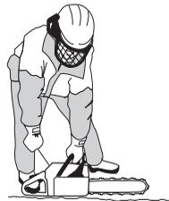
Halten Sie die Motorsäge mit festem Griff, in dem Sie die Handgriffe fest mit Daumen und Fingern umschließen.
