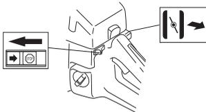
Wenn das Gerät mit Dekompressionsventil (A) ausgerüstet ist: Dekompressionsventil eindrücken, damit der Druck im Zylinder reduziert wird; dadurch wird das Anspringen erleichtert. Das Dekompressionsventil sollte beim Anlassen immer betätigt werden. Wenn die
