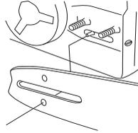
Die Kette durch Drehen der Kettenspannschraube im Uhrzeigersinn (einen Kombischlüssel verwenden) spannen. Die Kette soll gespannt werden, bis sie auf der Schienenunterseite nicht mehr durchhängt.
