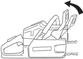
Die Schienenmutter lösen und den Kupplungsdeckel (Kettenbremse) abnehmen. Den Transportschutz (A) entfernen.
