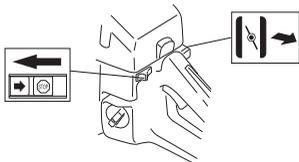
Če je stroj opremljen z dekompresijskim ventilom (A): S pritiskom na ventil zmanjšate pritisk v cilindru, kar bo olajšalo vžig stroja. Pri vžigu vedno uporabljajte dekompresijski ventil. Ko je stroj vžgal se ventil samodejno vrne v svoj prvotni položaj.
