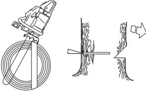
Der Fällschnitt soll parallel zur Kerbschnittlinie abschließen, so dass der Abstand zwischen beiden Schnitten mindestens 1/10 des Stammdurchmessers beträgt. Der nicht durchgesägte Teil des Stamm wird als Brechmaß bezeichnet.
