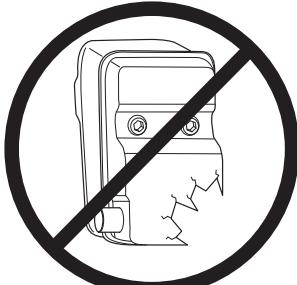
Pravidelne kontrolujte, či je tlmič výfuku pevne pripevnený k motoru.
